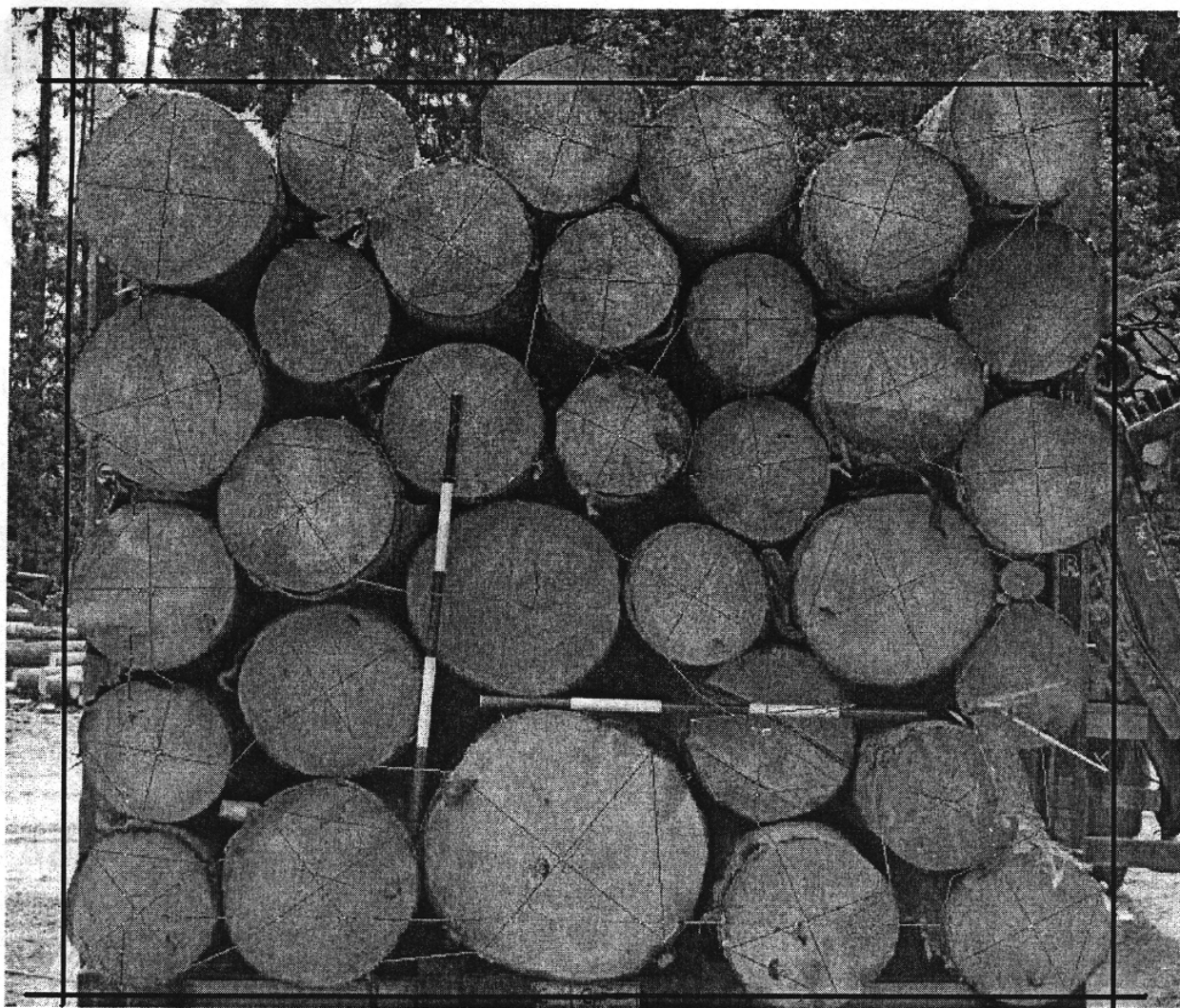
Obr. 1 Ohraničenie plochy čela nákladu pre účely stanovenia šírky a výšky nákladu
