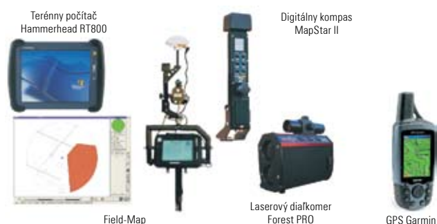
Obrázok 2.2–1 Technológia Field-Map a GPS Garmin GPSMAP 60 CS
